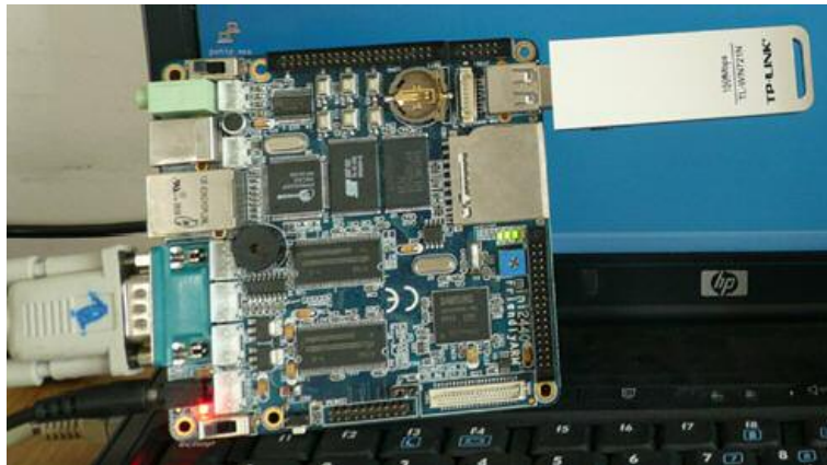
Hình 4. Kết quả hiện thực module wireless
