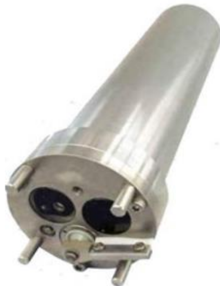
Hình B.2 - Đầu đo độ đục ghi INFINITY-Turbi ATU75W2-USB
