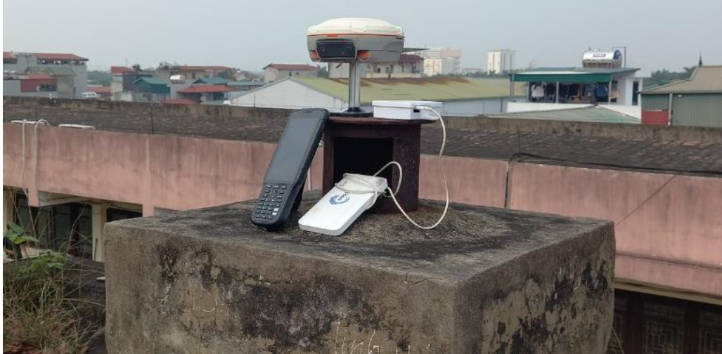
Hình 8. Anten GNSS và cảm biến gia tốc đặt trên mốc cố định.
